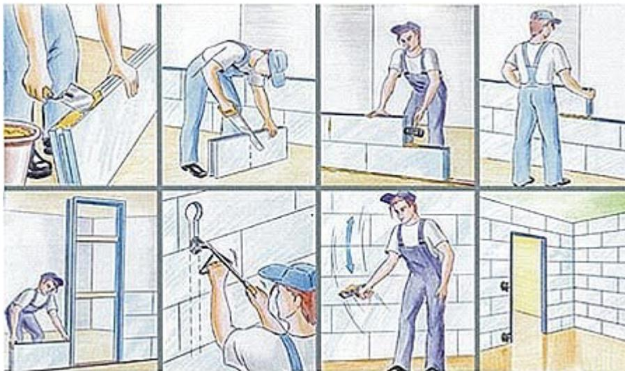
Рисунок 1. Последовательность устройства пазогребневых плит
