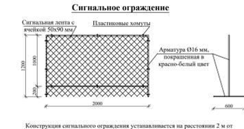
Конструкция сигнального ограждения устанавливается на расстоянии 2 м от первого вылета 1,3 м и более в границе опасных зон. Ограждение должно быть непрерывным (достигается связкой двух рядов стоящих секций).
