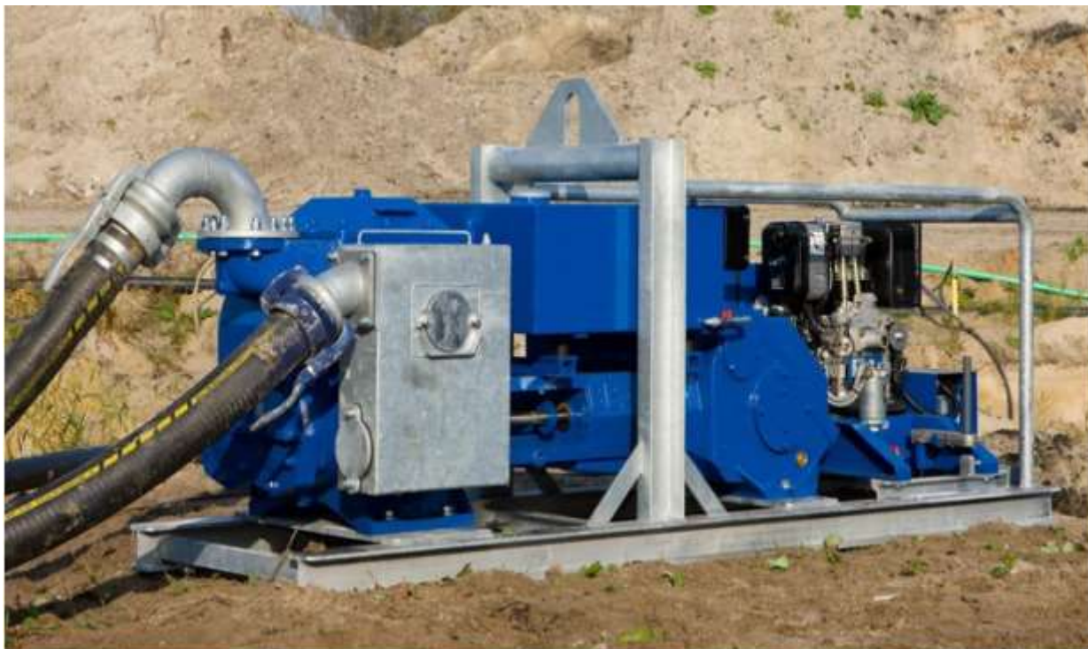
Установка РТ90НА ВС (макс. 90 м3/ч, макс.напор 20м. высота всасывания 9,6м)
