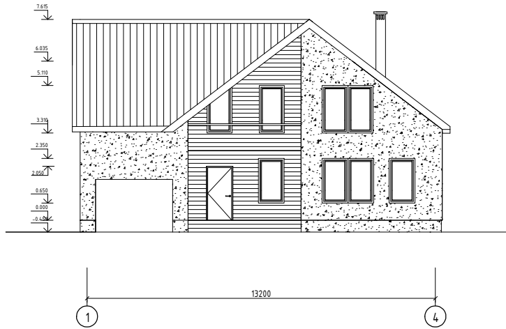
Фасад в осях 1-4 в М 1:100
