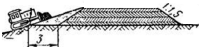
Рисунок 8.1 Заезд тяжелой техники по присыпаемой берме
