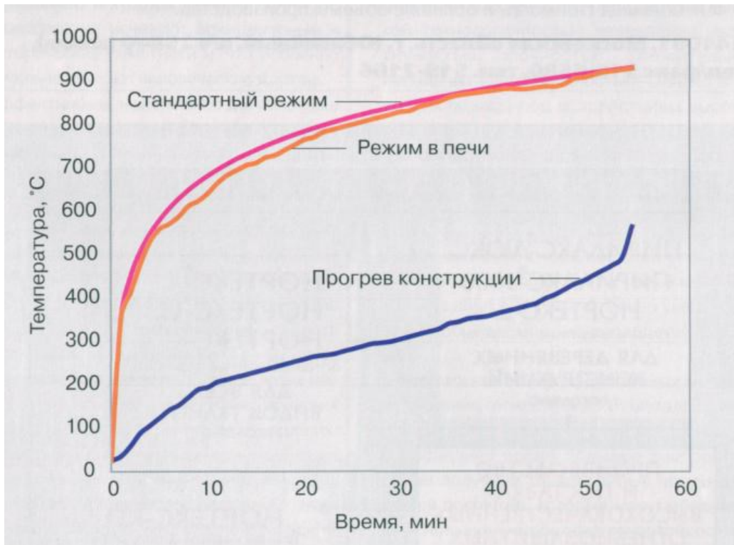
Рис. 1. Скорость прогрева стандартной конструкции (двутавр № 20) с огнезащитным тонкослойным покрытием при испытании
