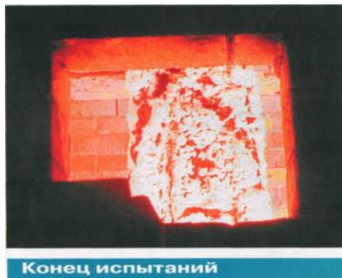
Рис. 2. Изменение внешнего вида огнезащитного покрытия при испытании.
