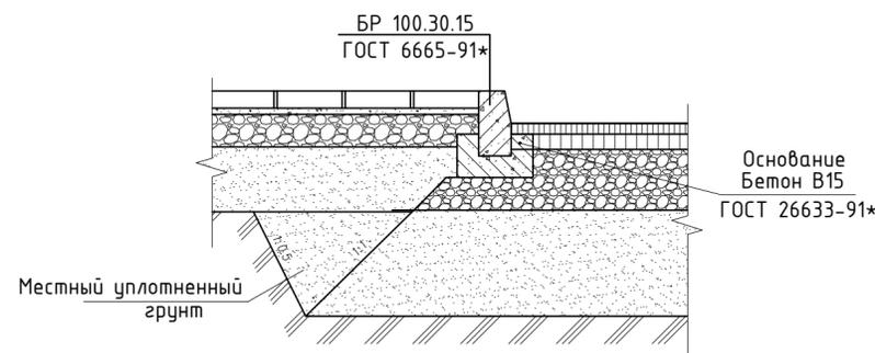
Сопряжение проезда с газоном Узел "А"
