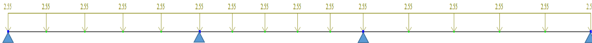
Рисунок 4.19. Расчётная схема монолитной плиты
