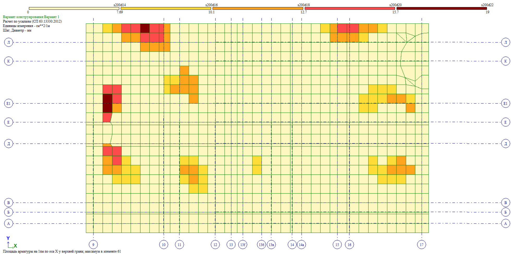
Рис.6. Площадь арматуры у верхней грани фундаментной плиты по оси X (карстовая воронка расположена в осях 17/К секции В)
