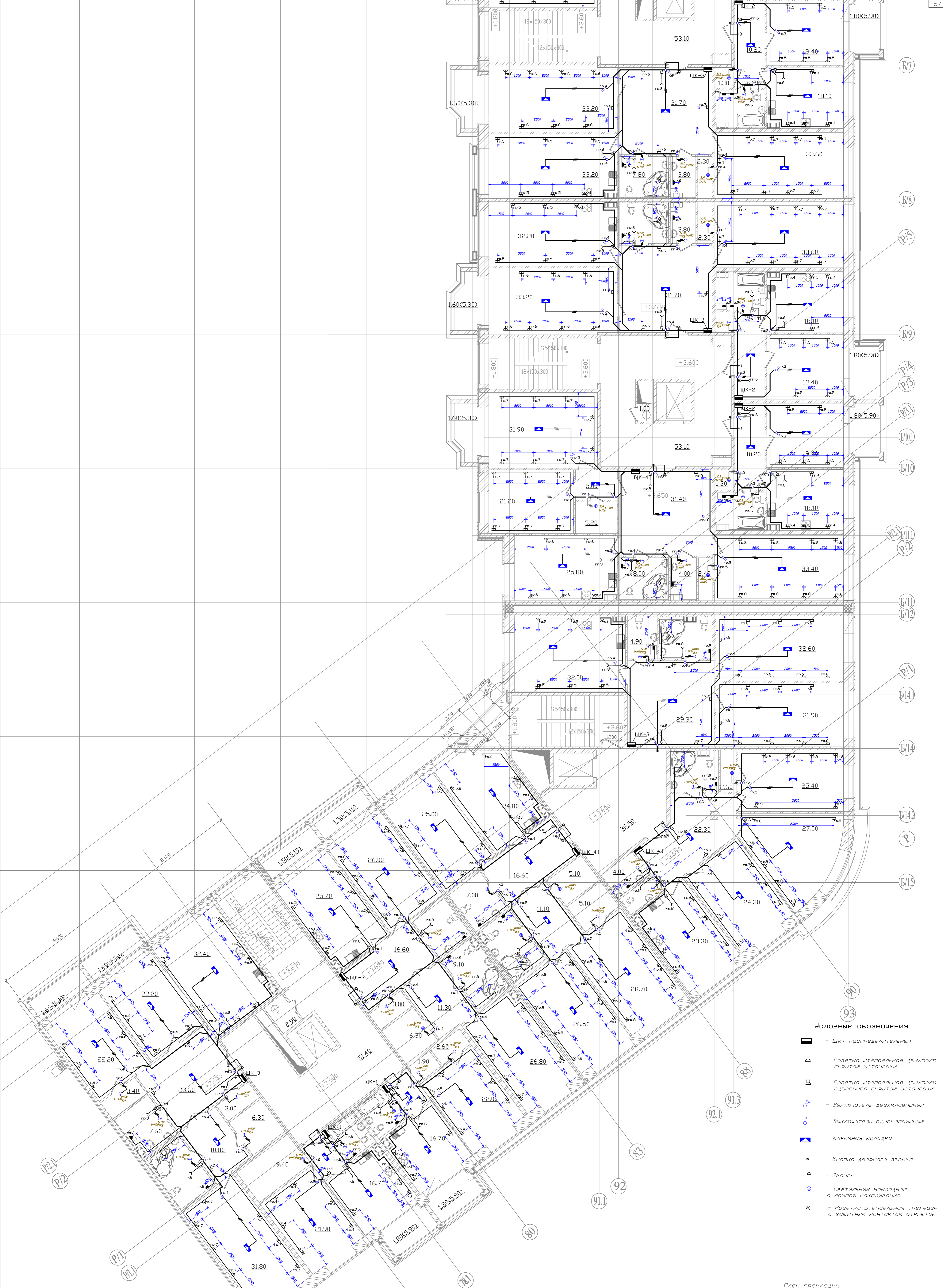
План прокладки осветительной и розеточной сети (этаж 2 часть 2)
