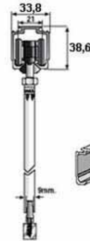
Конструкция двери купе с верхним расположением направляющих в спальне и кладовой
