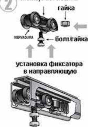
Конструкция двери купе с верхним расположением направляющих в спальне и кладовой
