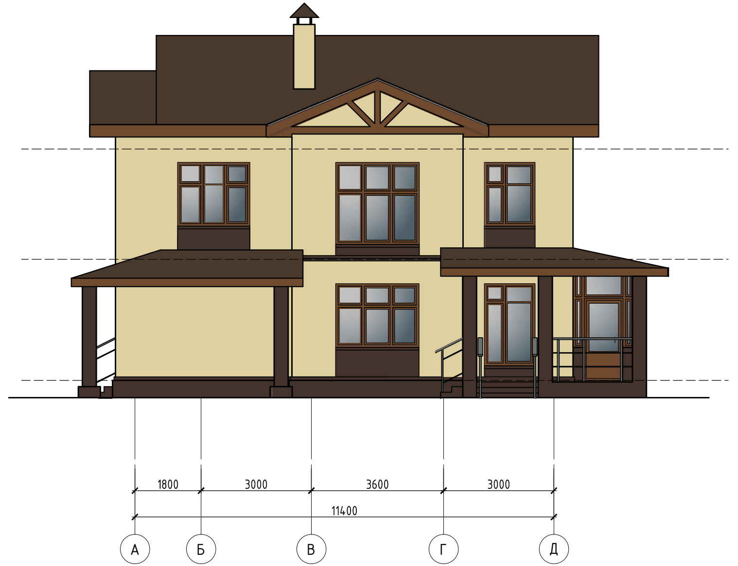
Фасад в осях А-Д
