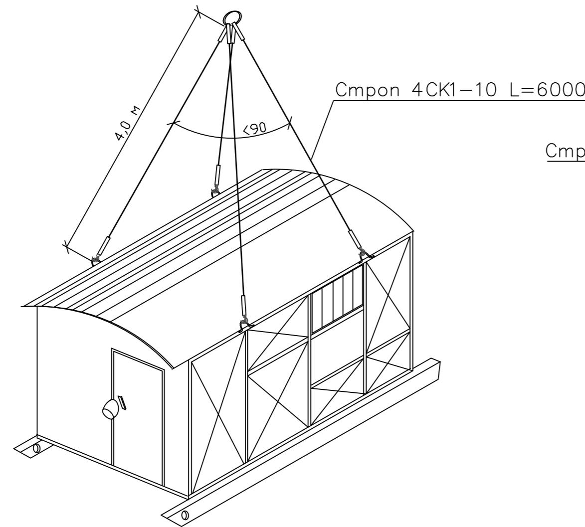
**Схемы строповок элементов,
