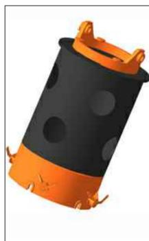
Дрейтеллер служит механизмом присоединения и передачи вращения от вращателя к обсадным трубам. Типоразмер дрейтеллера аналогичен размеру обсадных труб. Для обсадных труб Leffer 1080/1000 мм используется дрейтеллер 1080/1000 с 4 замками. Возможно использование дрейтеллера отличного типоразмера с переходником.
