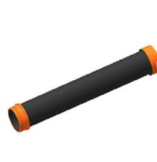
Бетонные трубы служат для транспортировки бетонной смеси на дно скважины. Применяемые типоразмеры бетонных труб в зависимости от подаваемой фракции: 219 мм, 245 мм, 325 мм; Применяются секции бетонных труб длиной 1, 2, 3, 4, 5, 6 метров. Для бетонирования в данной технологической карте приняты бетонные трубы внутренним диаметром 250-325 мм.
