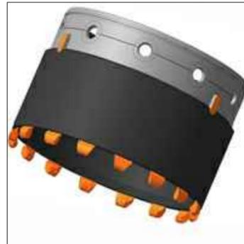
Разрушающая коронка на лидерную трубу выполняется из твердосплавных материалов и имеет высокую износостойкость и значительную массу. Для одностенных обсадных труб Leffer применяется ножевая секция с установленной разрушающей коронкой. Принятый типоразмер ножевой секции 1080/1000, длина 4 м.
