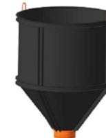
Воронка загрузочная служит для накопления и подачи бетонной смеси при бетонировании. Воронки до 1м<sup>3</sup> применяются без промежуточного накопления при бетонировании с помощью бетононасоса. При бетонировании непосредственно с помощью автобетононасоса объем бункера должен быть не менее объема бетонной трубы.
