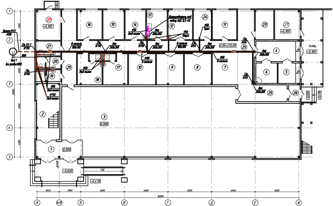
Фрагмент плана 2-го этажа с сетью К1 в осях 1-5 и А-Б. М1:100.
