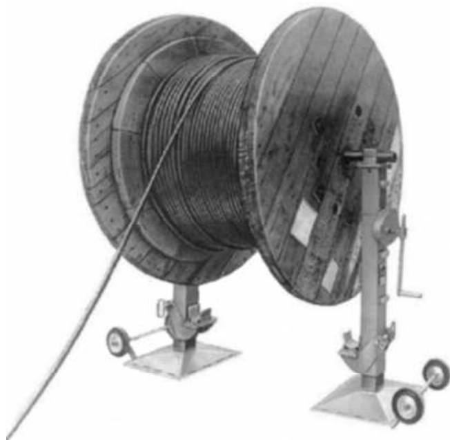
Рис. 3.1. Установка кабельного барабана на домкратах.
