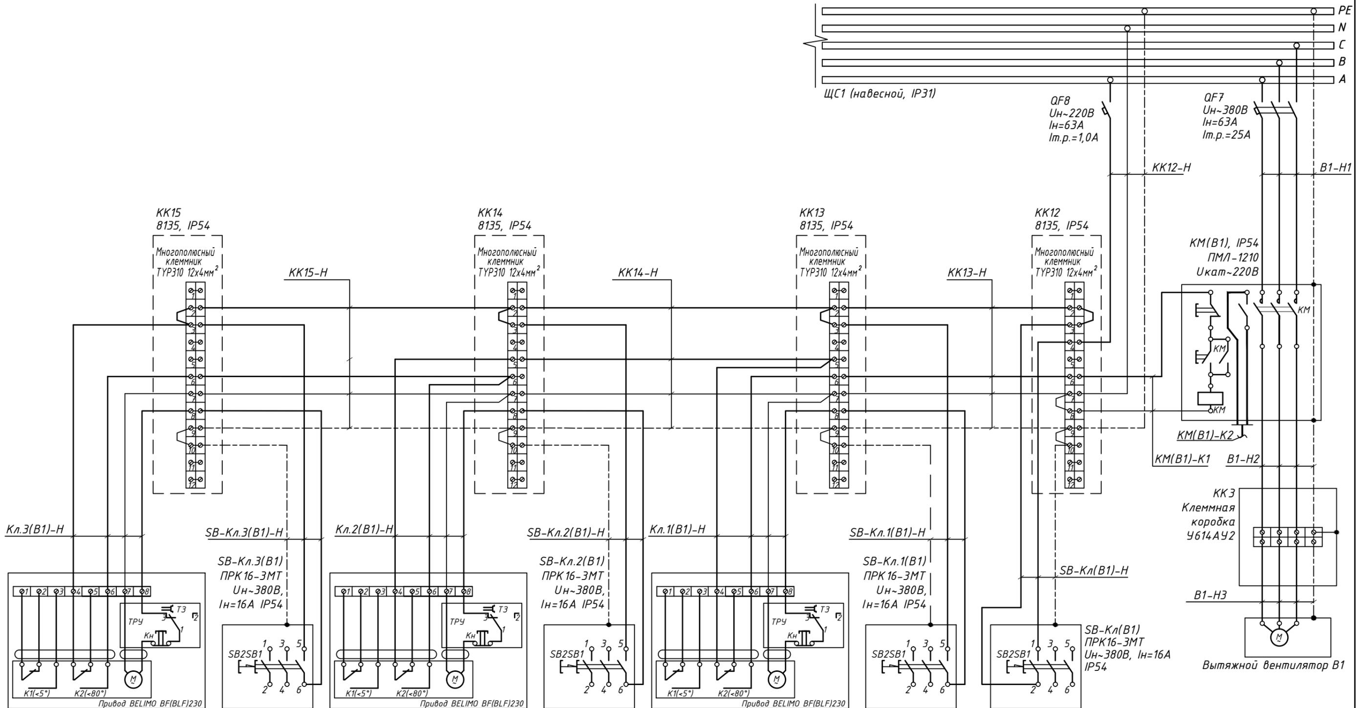
Противопожарный нормально открытый клапан КЛОП (Кл.3(В1)) (без напряжения заслонка закрыта)
