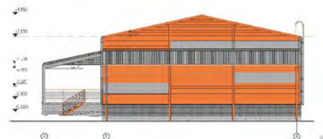
Варианты раскладки сэндвич-панелей, складское здание (Б)
