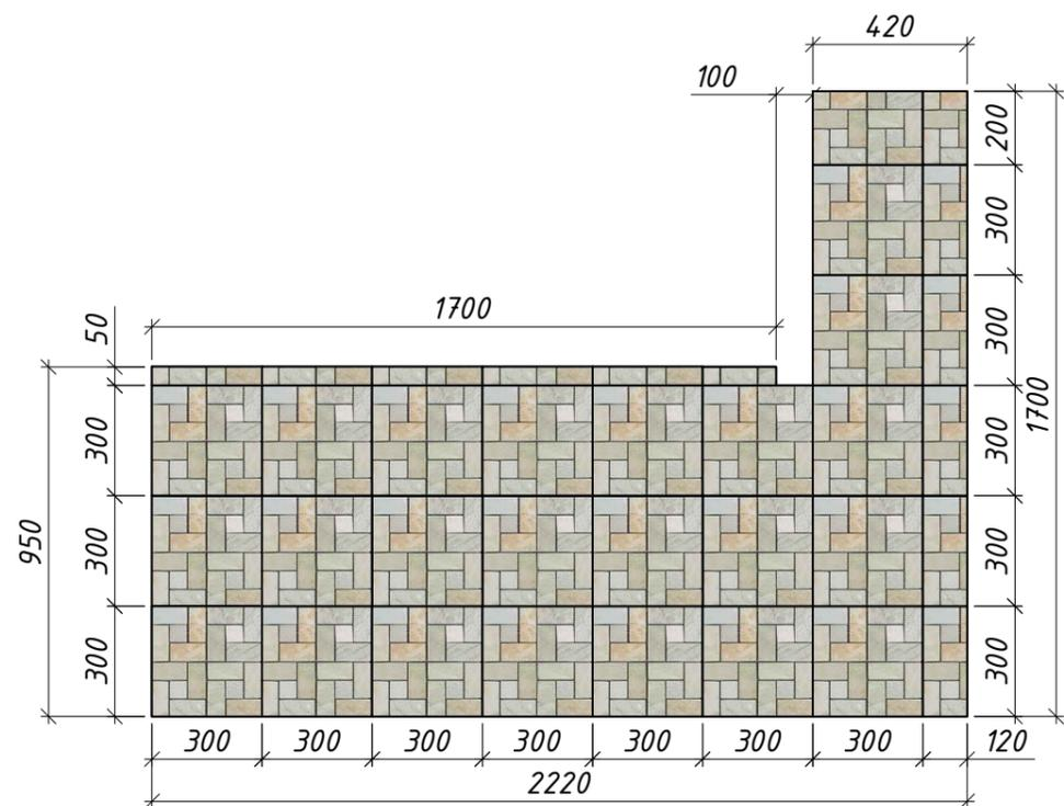
План-схема раскладки плитки (Туалет). М 1 : 20.
