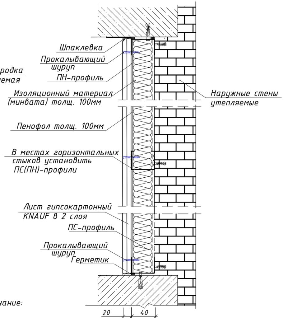
Узел 3. Схема монтажа перегородок из ГКЛ.
