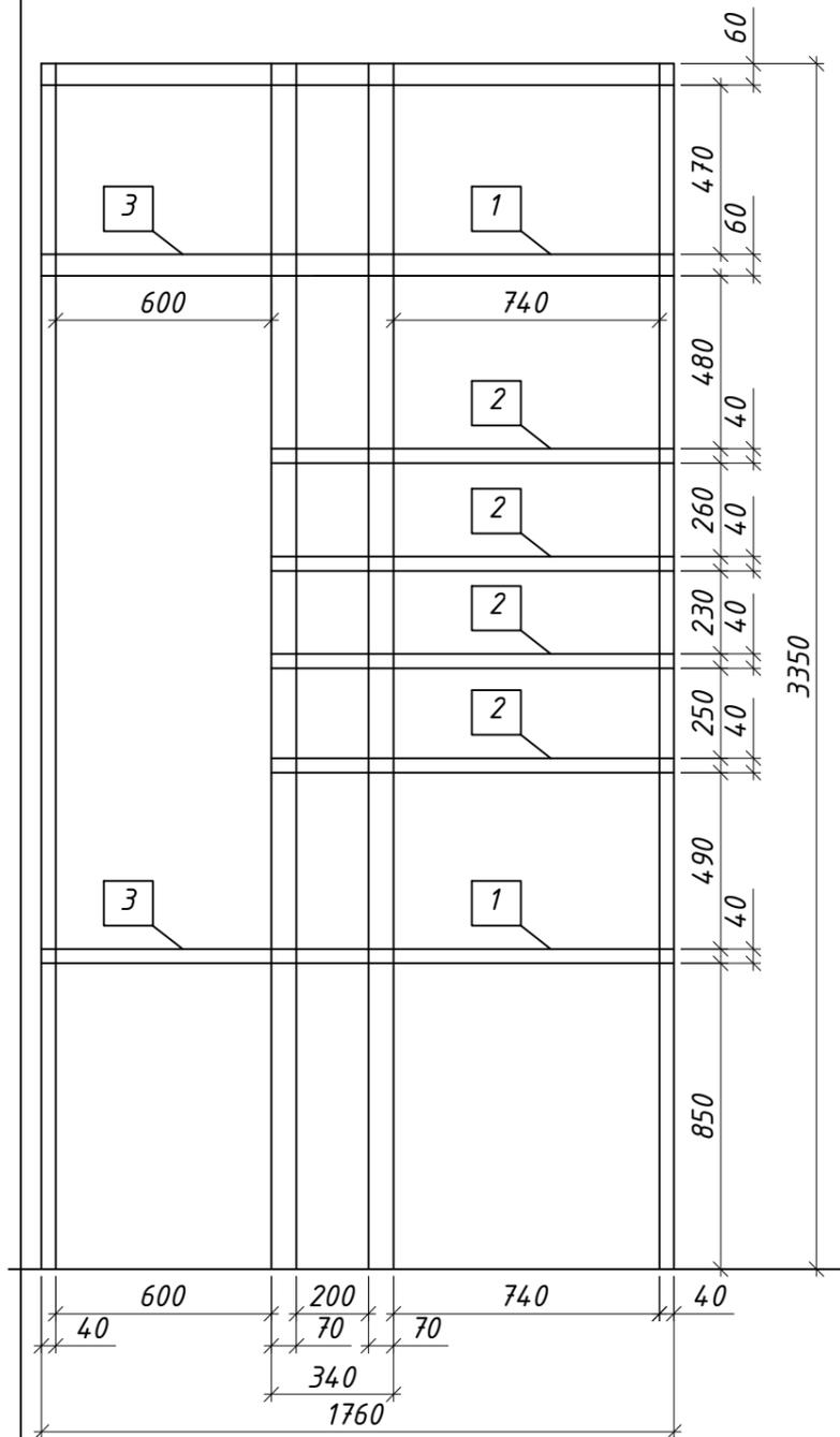
Полки. Схема раскройки.
