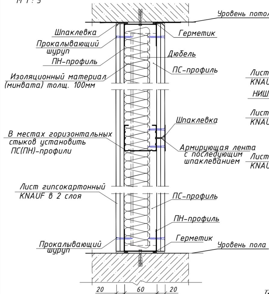
Узел 2. Схема устройства ниш в перегородках из ГКЛ.
