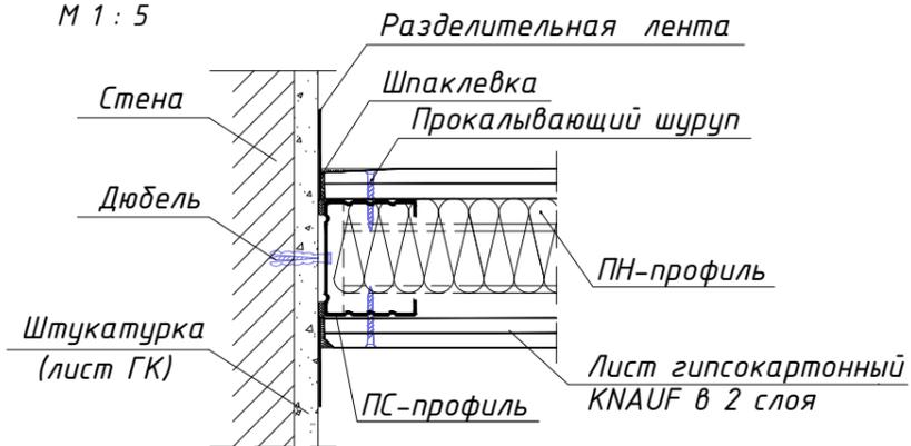
Узел 4. Схема монтажа дверных блоков М 1 : 5
