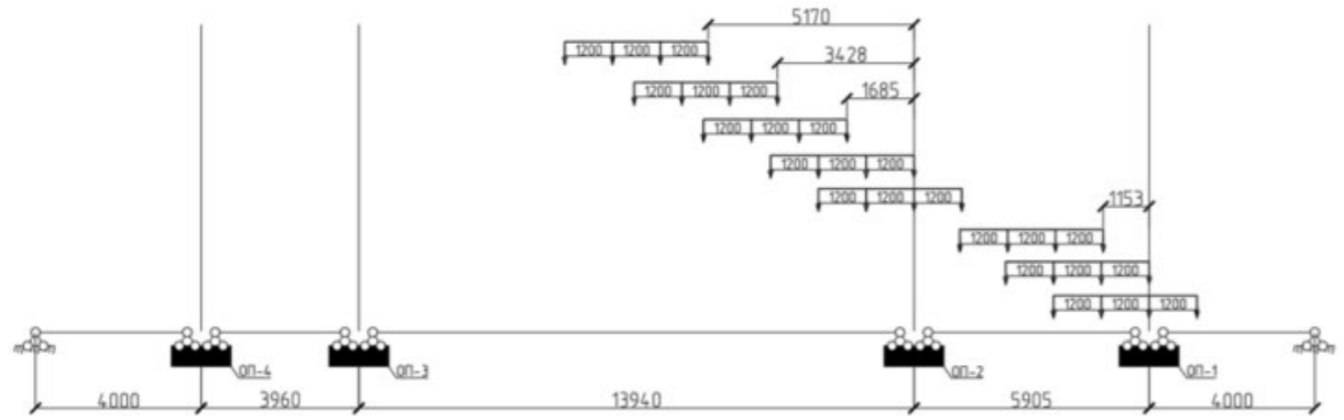
Рисунок х – Продольная схема загрузки временной вертикальной нагрузкой от транспортных средств АК
