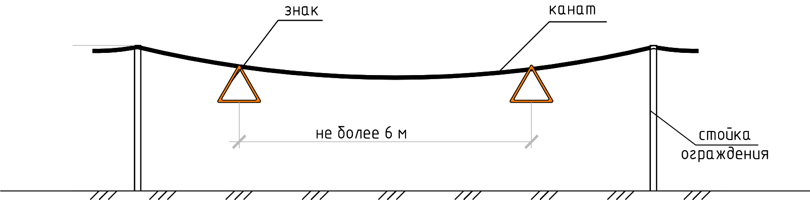
Конструкция сигнального ограждения по ГОСТ 12.4.059-89
