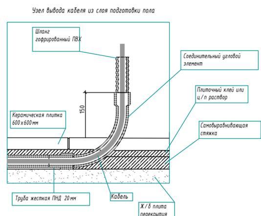
Схема прокладки ПНД труб для кабелей в полу
