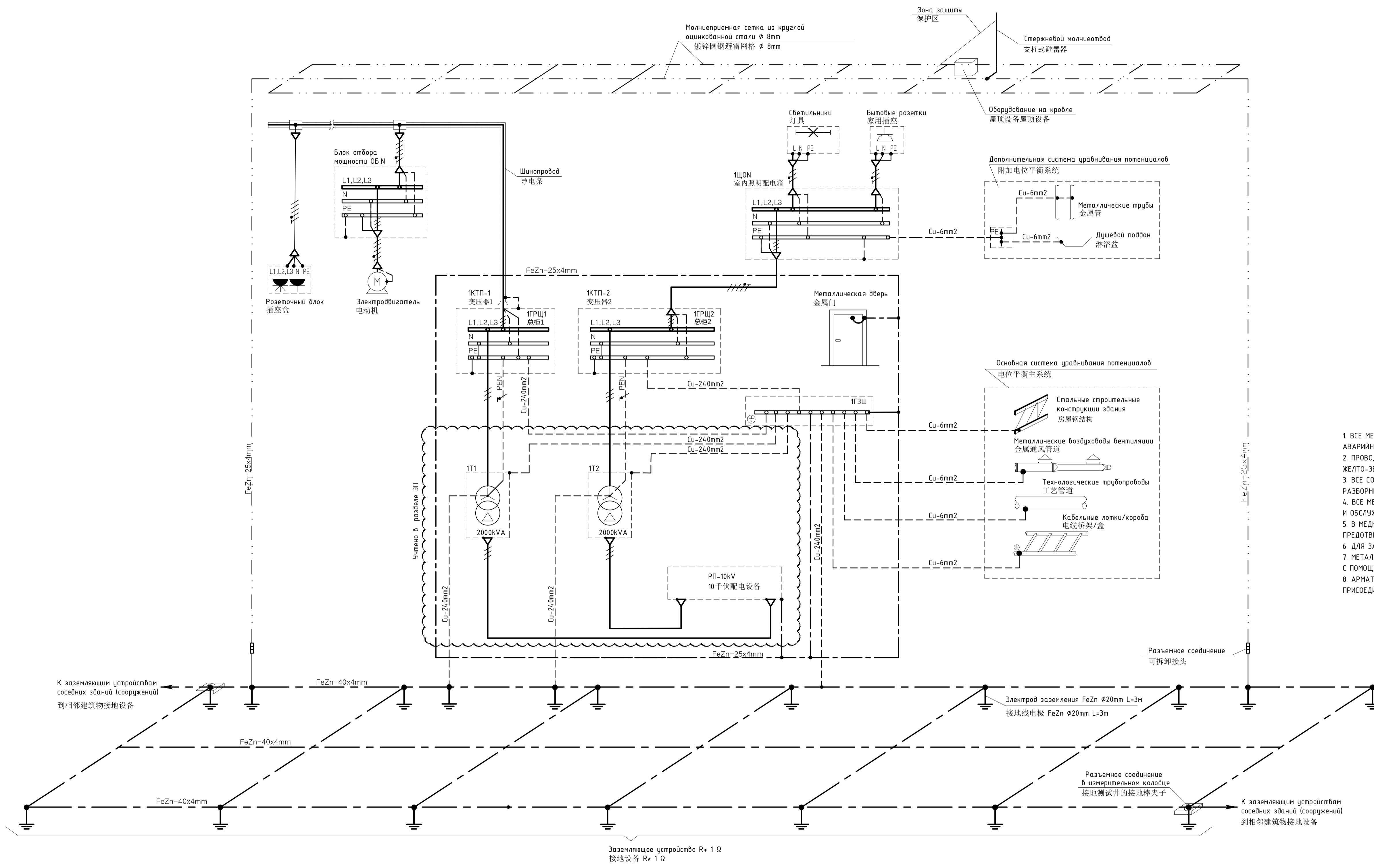
1. ВСЕ МЕТАЛЛИЧЕСКИЕ ЧАСТИ ОБОРУДОВАНИЯ, КОТОРЫЕ МОГУТ ОКАЗАТЬСЯ ПОД НАПРЯЖЕНИЕ ВО ВРЕМЯ АВАРИЙНЫХ РЕЖИМОВ ДОЛЖНЫ БЫТЬ ЗАЗЕМЛЕНЫ
