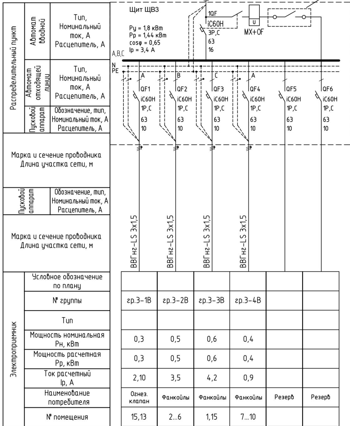
1. Из схемы противопожарной сигнализации. Контакт замыкается при пожаре, система вентиляции отключается.
